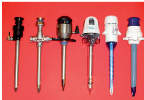
Abb. 1 a) Trokare für die laparoskopische Chirurgie (exemplarische Auswahl, v.l.n.r.: Trokar mit Magnetventil (Fa. MTB), Standard-Trokar mit Trompetenventil (Fa. Dufner), TroQ®-Trokar (Fa. Olympus), Xcel®-Trokar (Fa. J & J Ethicon Endo-Surgery), Convertible®-Trokar (Fa. Applied Medical), Versaport®-Trokar (Fa. Covidien). b) Trokare und Instrumente bei laparoskopischer Fundoplicatio.
